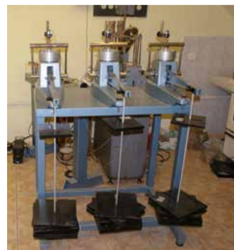
Gruntų mechanikos laboratorija. Odometrinis prietaisas, skirtas deformaciniams gruntų savybėms tirti. (2021 m., sausis). S. Gadeikio nuotr.
