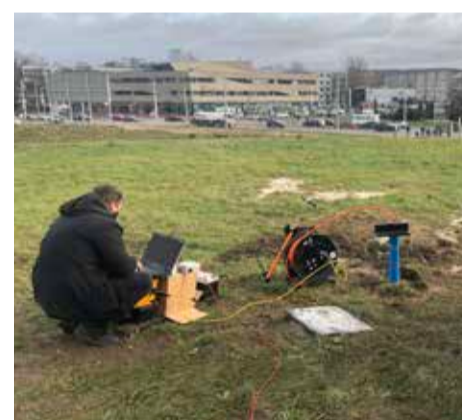
Geofiziniai seisminiai tyrimai gręžinyje (Vilnius, Kareivių g., 2022 m.) S. Gadeikio nuotr.
